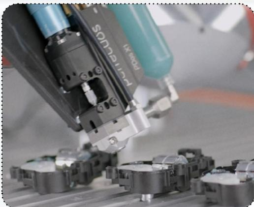
Bild 3: Mit 300 Hz Taktfrequenz wird eine hohe Dosierfrequenz bei einer Entfernung von 50 mm bei horizontalen und Überkopfaufnahmen erzielt (Bild: perfectdos GmbH)
