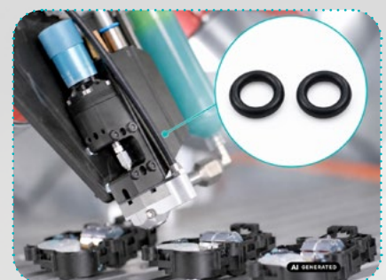
Das Ventil benötigt nur zwei Standard-NBR-Dichtungen, die kostenseitig den Unterschied machen (Bild: perfecdos GmbH)
